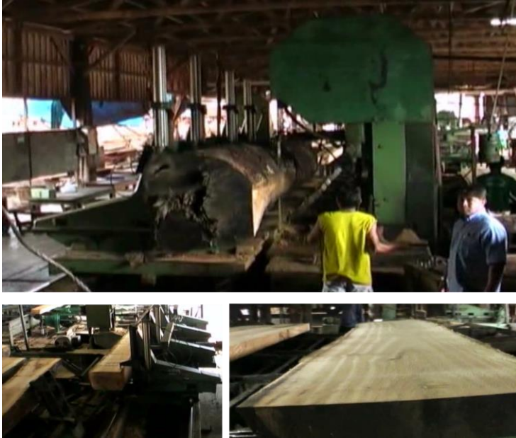
Figura 26 – Serraria com serras de fita na Vila Mainardi, no período de grande produção
