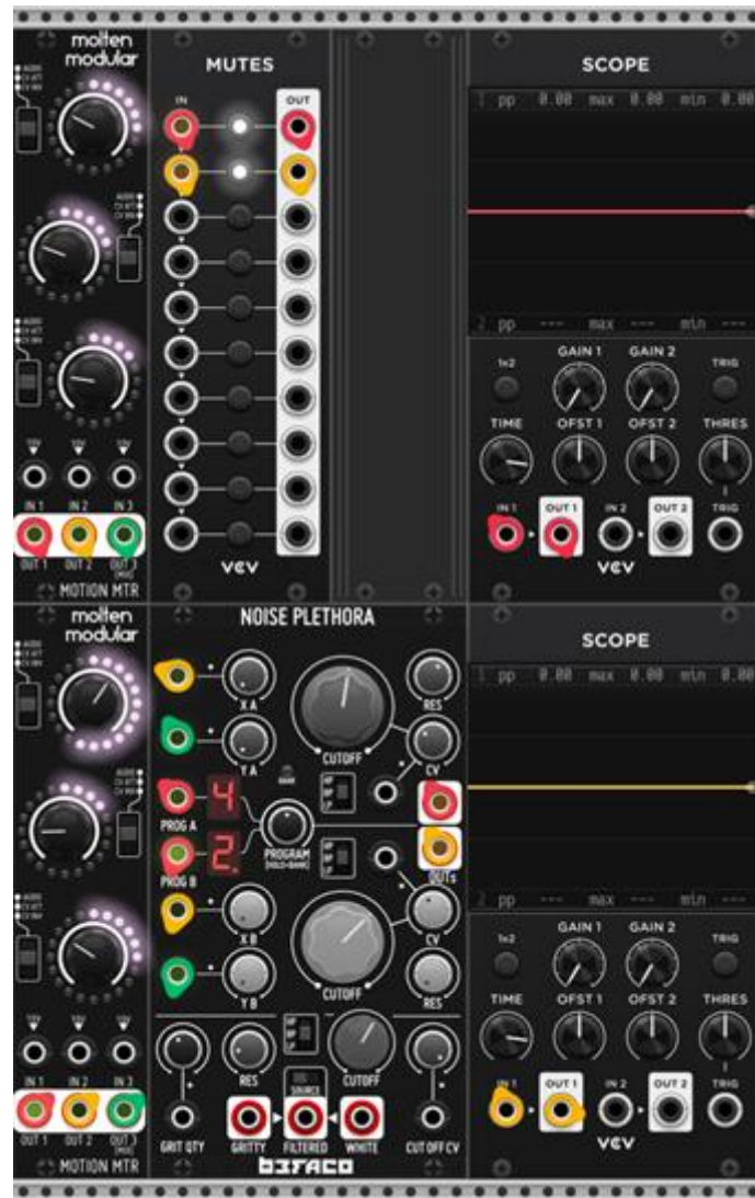
Figura 10: Detalhe da seção de controle direto do Noise Plethora, com os módulos Motion MTR, Mutes e Scope.
