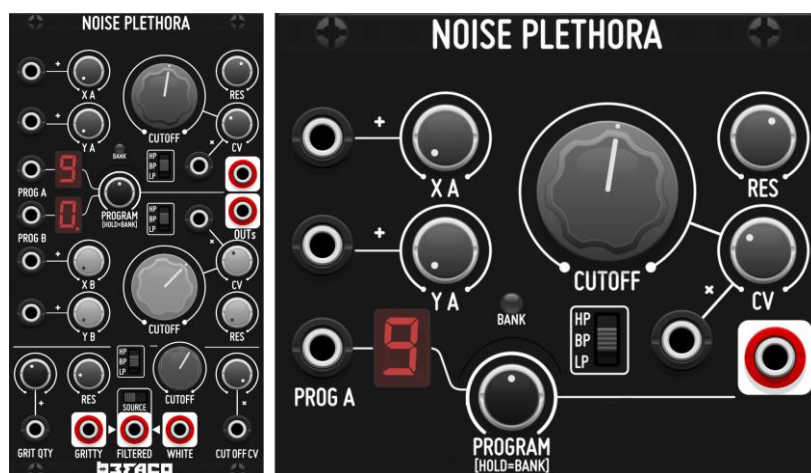
Figura 9: Módulo Befaco PLETHORA (esquerda) com destaque aos controles da primeira voz (direita).
