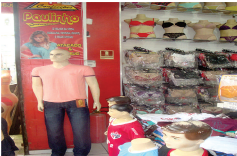
Foto 1 – Sinalização de Equipamento confundindo-se com o fundo (parede).
