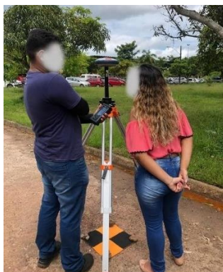
Figura 4 – Coleta de ponto de controle, com GPS geodésico e com gabarito fixado ao solo
