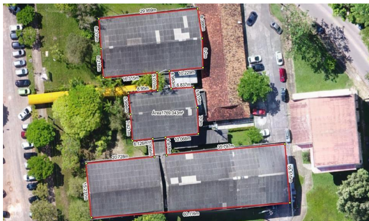
Figura 10 – Vetorização da imagem adquirida por RPA na escala 1:450
