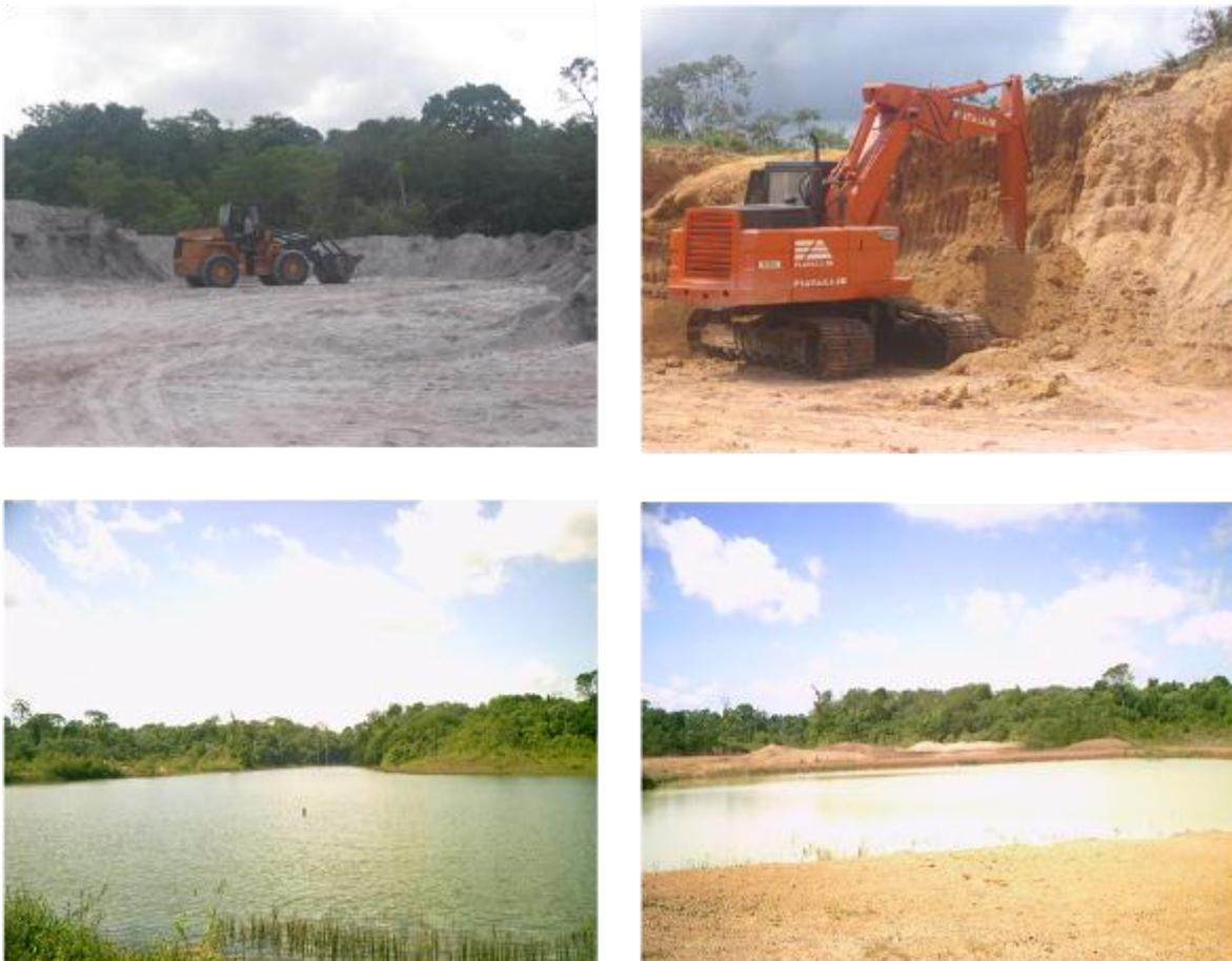
**Figura 3:** Área de extração mineral na porção nordeste de Caratateua. Nas fotografias acima nota-se o rebaixamento da superfície devido à formação das “cavas” ou “covões”. Há também a formação de lagos pelo acúmulo da água da chuva, ou em virtude da alteração do lençol freático
