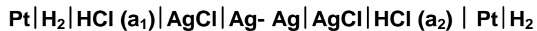
Figura 8.9 Célula de concentração sem junção líquida . Duas células químicas, com soluções eletrolíticas de mesma natureza química, porém com concentrações diferentes, estão conectadas em série. Observa-se que não existe contato direto entre as soluções eletrolíticas.
