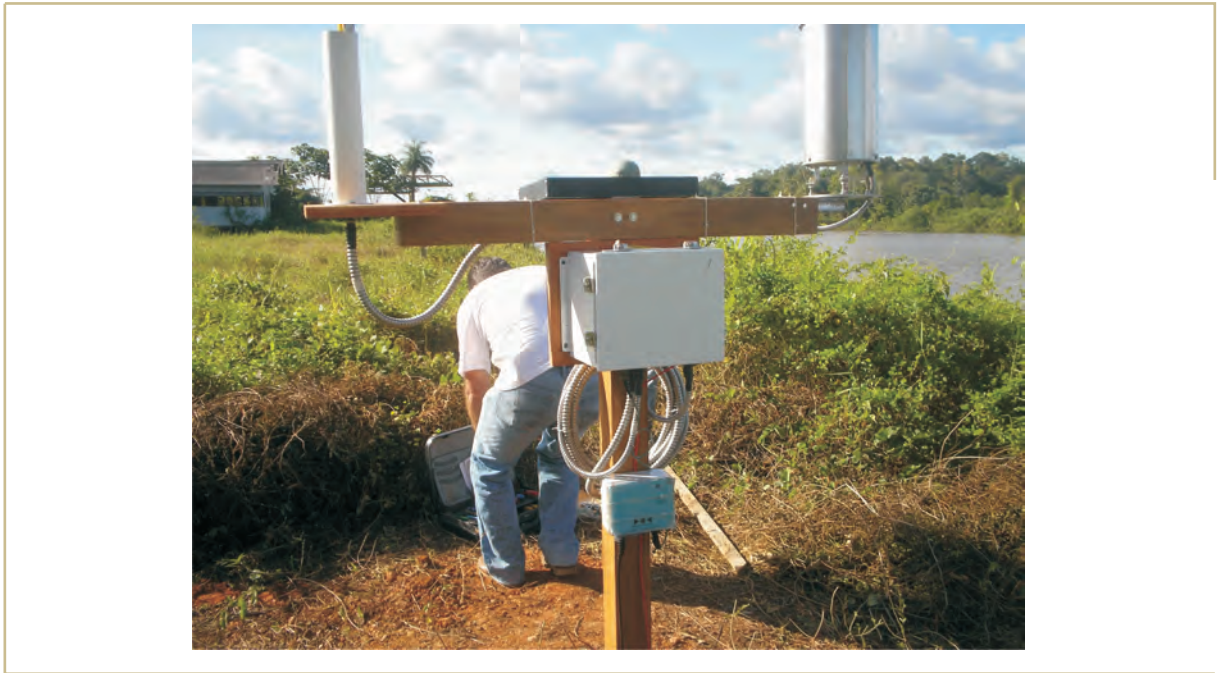
Figura 1. PCD hidrológica NHMET/IEPA instalada em 2008 pelo Projeto REMETAP no rio Matapi, Santana.
