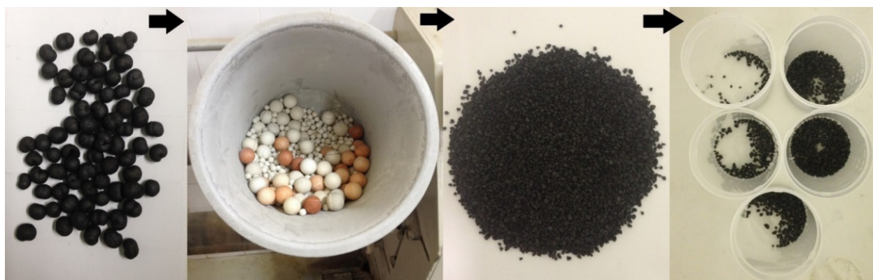
Figura 01- Etapas da quebra em moinho de bolas, peneiramento do material quebrado e pesagem do carvão ativado do caroço de açaí.
