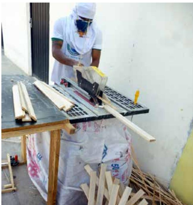
**Figura 16** - Artesão Pirias cortando réguas de miriti na máquina.
