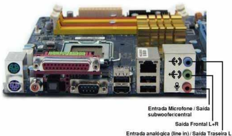
Figura 5: Placa-mãe de um microcomputador (visão traseira).
